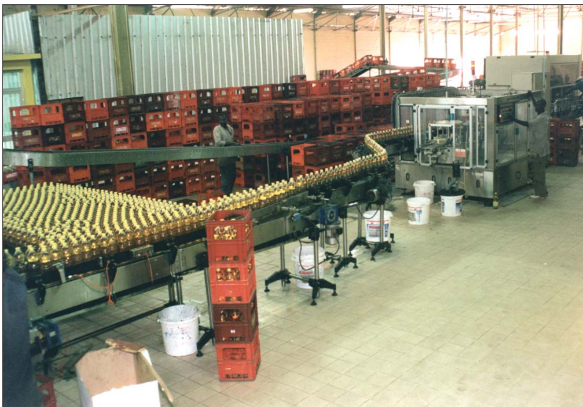
Usine SONACOS : table d'accumulation, entrée étiqueteuse (Sénégal).
